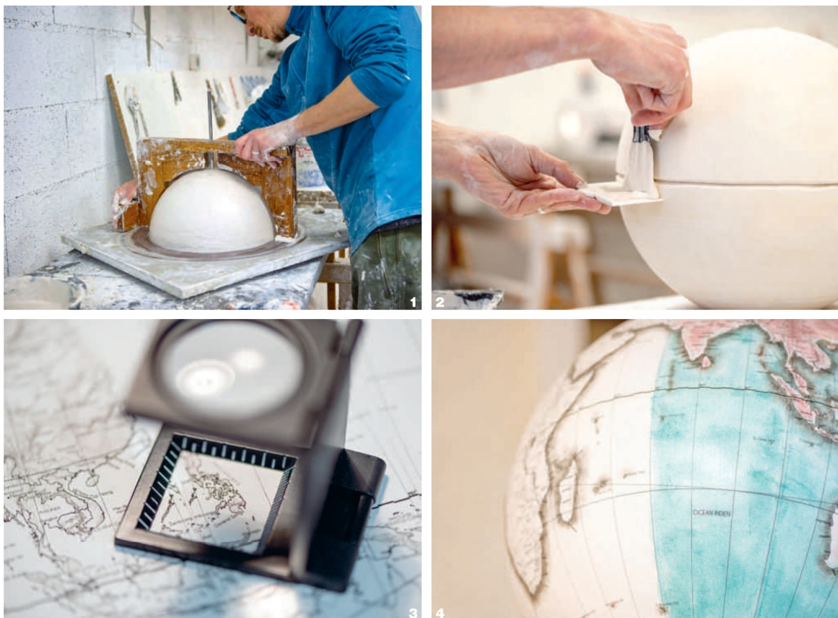
Pour fabriquer ses globes (5), Alain Sauter mélange du plâtre en poudre, des fibres et de l'eau, qu'il coule dans le moule de deux demi-sphères (1), avant de les recouvrir de toile de jute ou de papier (2). Il y appose ensuite une carte (4) dessinée grâce à des encres au carbone (3) et imprimée sur du papier très fin.
