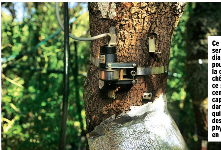
**Ce dendromètre sert à mesurer le diamètre du tronc, pour déterminer la croissance des chênes. Au total, ce sont plusieurs centaines de capteurs installés dans la forêt qui enregistrent des paramètres physico-chimiques en continu.**
